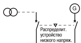
Рис. D16 : Подсоединение резервного генератора
