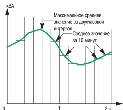
Рис. C10: Максимальное среднее значение мощности за двухчасовой период
