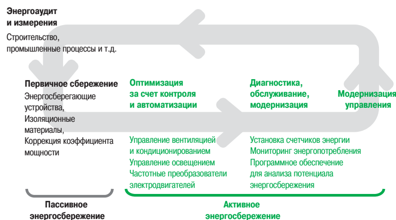
Рис. К6. Цикл непрерывного повышения энергоэффективности
