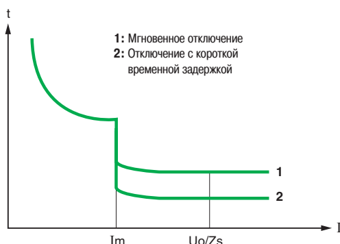
Рис. F14: Отключение системы TN автоматическим выключателем
