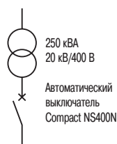
Рис. Н44: Пример установки автоматического выключателя на выходе трансформатора, расположенного на потребительской подстанции
