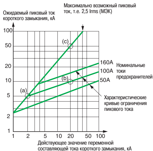
Рис. Н16: Зависимость ограниченного пикового тока от ожидаемых действующих значений переменной составляющей тока короткого замыкания для низковольтных плавких предохранителей
